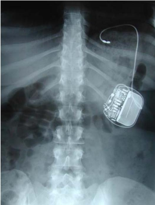
Das IGS-System besteht aus einem Implantierbaren Gastrostimulator (IGS) und einem Leitungsdraht (siehe Abb. 1) sowie einem für den Arzt bestimmten Programmiergerät, Lesestift und Softwarepaket. Der IGS ist ungefähr so groß wie eine Taschenuhr (60 mm x 54 mm x 10,3 mm) und wiegt ca. 55 g. Der Leitungsdraht hat einen Durchmesser von 3 mm und eine Länge von 38,5 cm.
